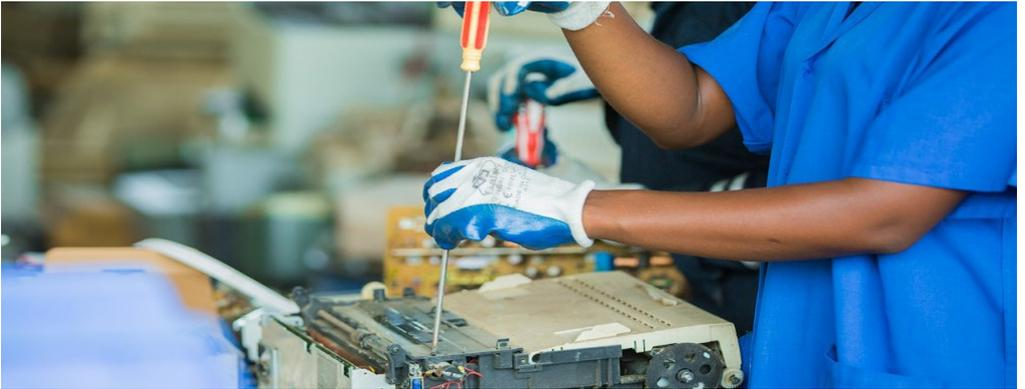
La manipulation des DEEE s'effectue avec des outils, des contenants et des moyens de fixation appropriés afin d'éviter d'endommager les Equipements Electroniques et assurer la sécurité des usagers.
